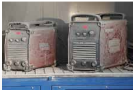
Ensayo de suciedad
